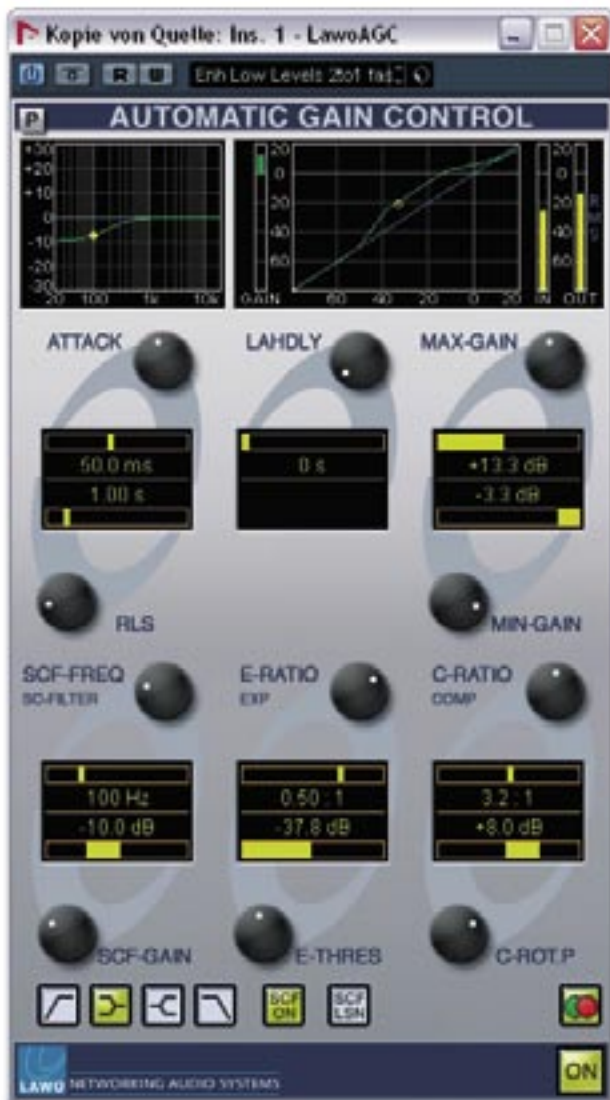
AGC kombiniert Expander und Kompressor zu einem leistungsstarken Leveling-Paket
